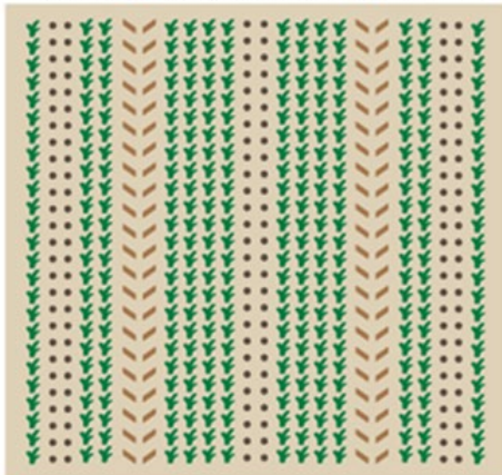
Semoir à 24 rangs, 12,5 cm d'espacement entre les rangs. 10 rangs (40%) non semé
